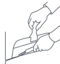
**Achtung:** Das Mikrofasertuch dient zum Schutz gegen Kratzer / Beschädigungen auf der Sichtseite. Niemals direkt mit dem Tapezierwerkzeug andrücken! Im gesamten Applizierungsprozess dürfen keinerlei Schmutzpartikel auf die Oberfläche gelangen. Beschädigte Stellen können in der Funktionalität beeinträchtigt sein.
