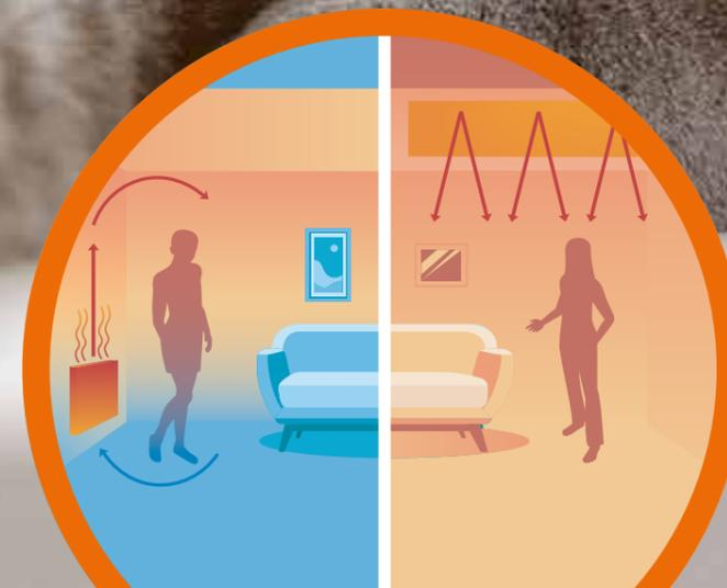
Im Vergleich zu konventionellen Heizungen wird bei Infrarot-Flächenheizungen keine Luft verwirbelt – wovon besonders Allergiker profitieren.
